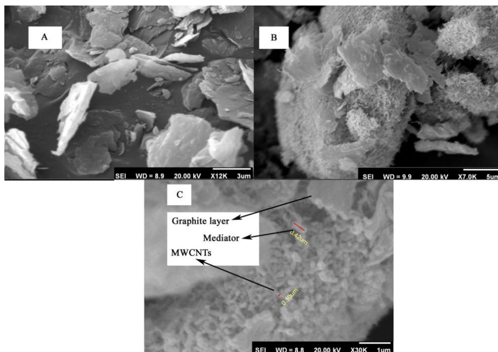
Fig. 1. SEM images of A) CPE, B) CNPE, and C) MC-CNPE.
